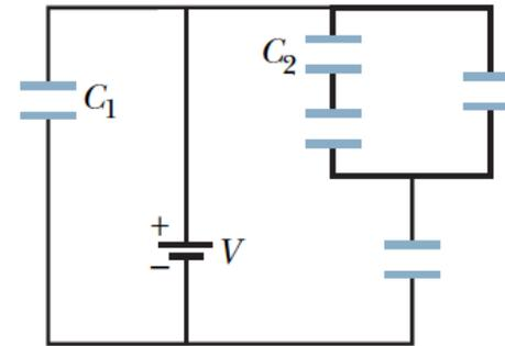
4) Considerando il sistema in figura, dati  $V = 9.0 \text{ V}$ ,  $C_1 = C_2 = 30 \text{ mF}$ , and  $C_3 = C_4 = 15 \text{ mF}$ . Qual è la carica nel capacitore 4?
