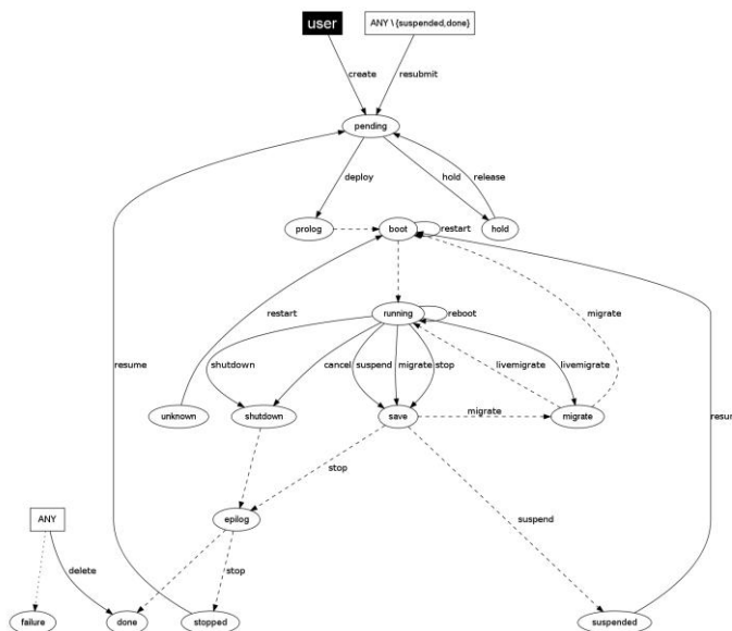
Figura 3 Ciclo di vita delle macchine virtuali
