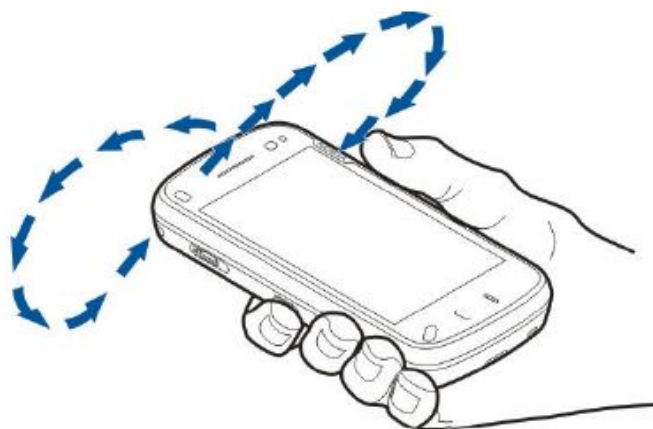
Figura 6.2 - Il movimento da eseguire per una corretta calibrazione della bussola
