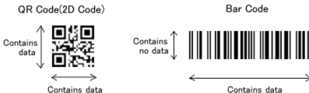
Figura 4.3 – Un barcode 2D (tipo QR) e barcode 1D: differenze.
